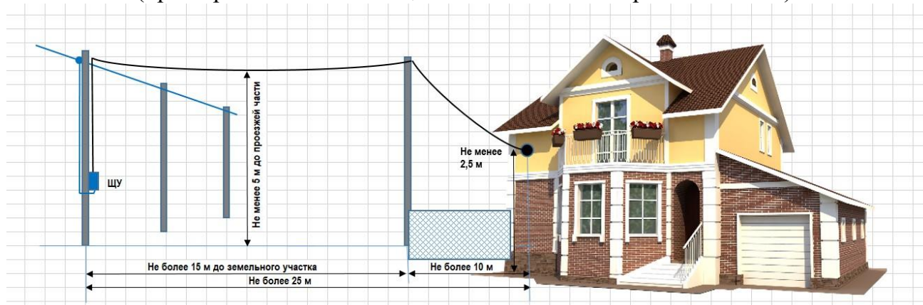
СХЕМА 1 ВОЗДУШНЫЙ ВВОД (при пересечении питающих сетей Заявителя проезжей частью)
